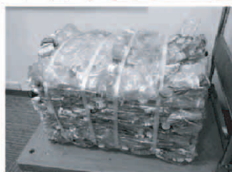
圧縮されたペットボトル。その後、粉砕され純粋なPETに
