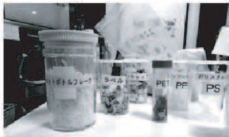
材質によって比重が異なるため、塩分濃度の高い水に入れて分別
